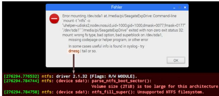
**Bild 3.4** Gescheiterte Einbindung einer 3-TB-USB-Festplatte
