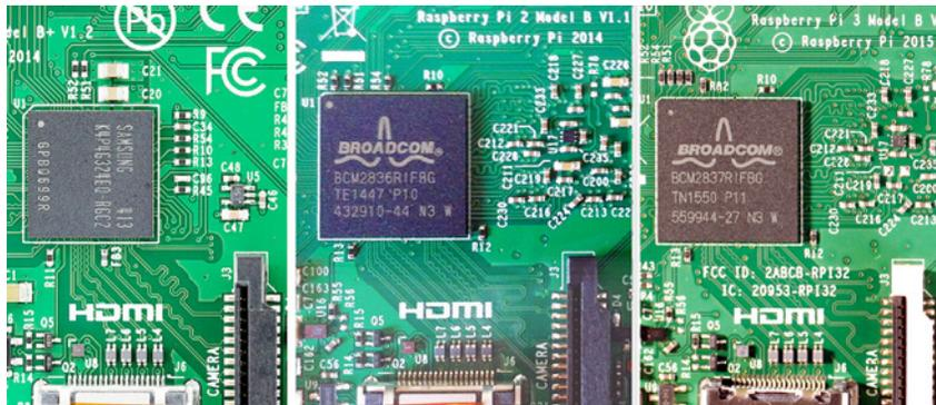
**Bild 1.12** System-on-a-Chip (B+, Pi 2 und Pi 3)
