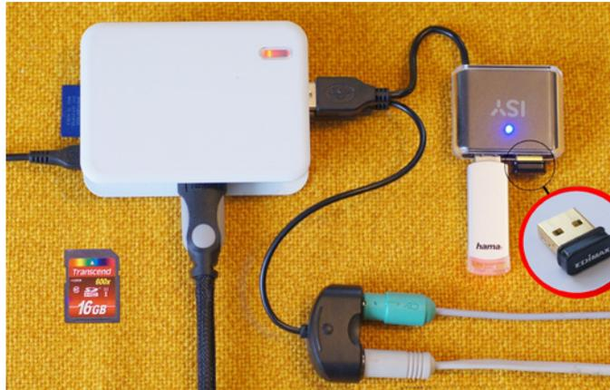
**Bild 1.1** Ein Raspberry Pi 1 mit PS2/USB-Adapter, passivem USB-Hub, USB-Stick und WLAN-Stick
