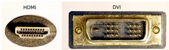
**Bild 1.24** Anschlüsse an einem HDMI-zu-DVI-Kabel
